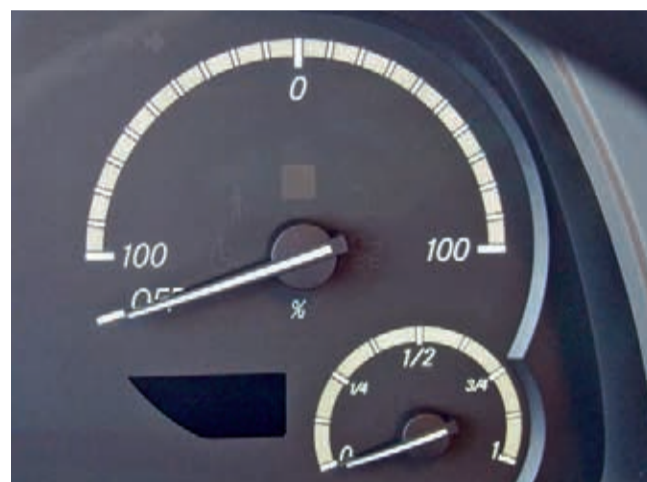
Powermeter statt Drehzahlmesser: Die große Skala zeigt an, ob Energie verbraucht oder zurückgewonnen wird. Der Zeiger der kleinen Uhr steht für den Ladezustand der Batterien
