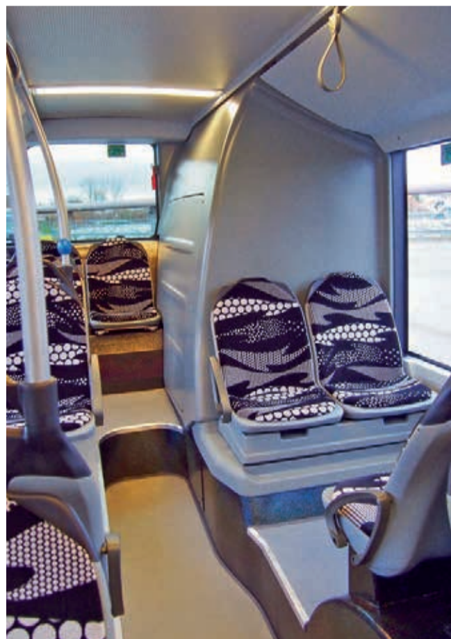
Malus bei der Raumökonomie: Im heckseitigen Motorturm stecken vier Batteriemodule und die Wasserkühlung
