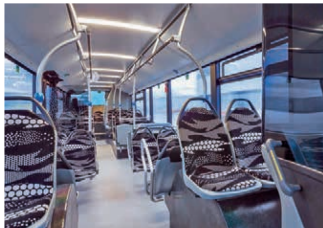
Neue Innenraumoptik: Sachlich elegante Note, neue Kassettendecke mit quer montierten LED-Lichtern
