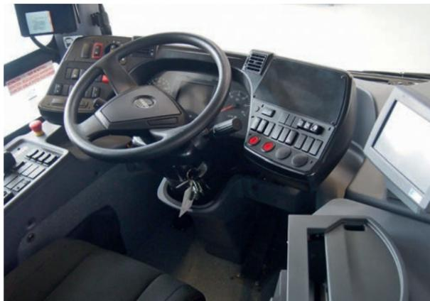
Auch VDV-konform lieferbar: Das Cockpit mit verstellbarem Armaturenräger (bei einem anderen Crossway LE fotografiert)
