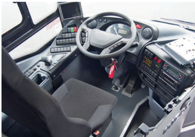
Die Standardvariante: Konzern-Cockpit mit Armaturen aus dem Stralis-Lkw – viele Schalter und Taster, aber schnell erlernbar
