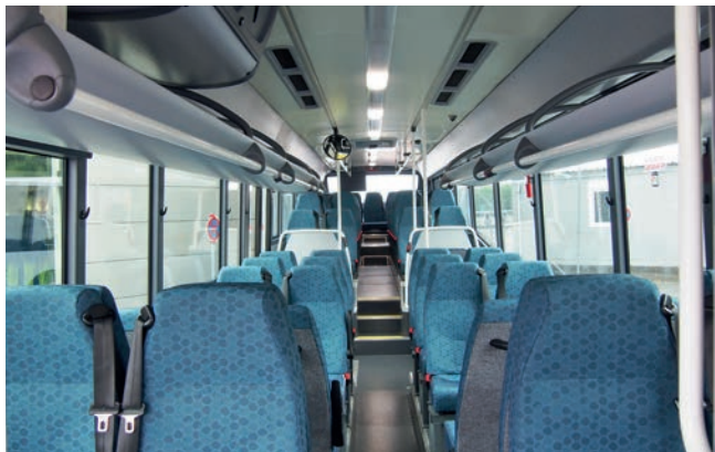
Volle Bestuhlung: Die Variante „Line“ stellt die Sitze auf Podeste, die „City“-Modelle kommen im Vorderwagen ohne aus
