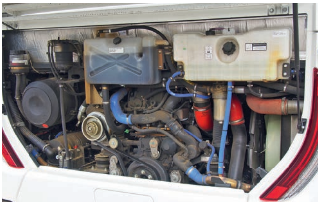
Mittig stehend im Motorraum: Kultivierter Cursor 9-Sechszylinder mit 8,7 l Hubraum und 360 PS
