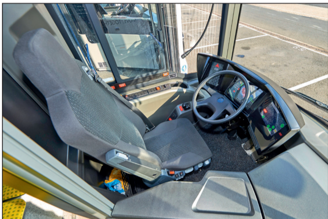
Willkommen im digitalen Zeitalter: Solaris präsentiert sein digitalisiertes Cockpit mit drei Monitoren
