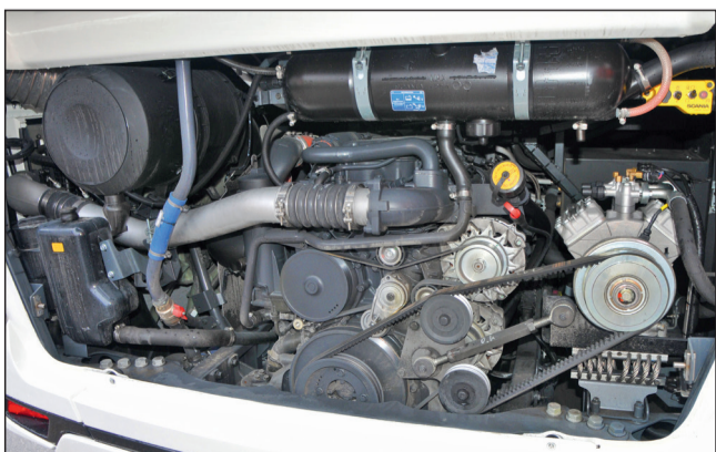
Schmale Motorklappe im Heck: Der neben dem Motor montierte Kompressor teilt sich beim Anlauf mit
