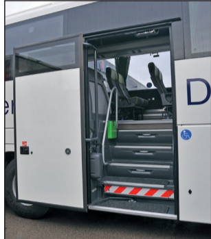
Mitteleinstieg mit 1.200 mm extrabreit: Hinter der zweiten Stufe ist ein Rollstuhlflift montiert
