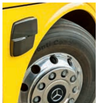
Mehr Sicherheit beim Rechtsabbiegen: Der Radarsensor des Sideguard Assist sitzt rechts hinter der Vorderachse
