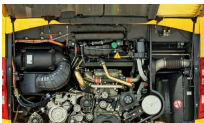
Das Triebwerk im Heck: Die stärkste Variante des OM470-Sechszylinders mit 456 PS ist vor allem bei hoher Auslastung und schweren Topografien empfehlenswert
