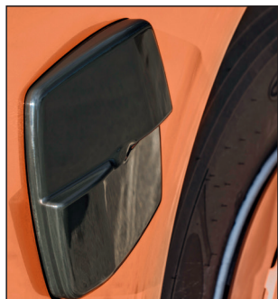
Radarsensorik für den Sideguardassistent: Zwei Nahbereichssensoren am Radlauf rechts überwachen die ganze Länge des Fahrzeugs. Die seitliche Überwachungszone hat eine Breite von 3,75 m
