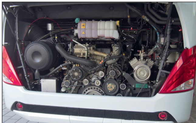
Gut gefüllter Motorraum: Stehender D26-Sechszylinder mit wahlweise 420 oder 460 PS, motorfester Klimakompressor
