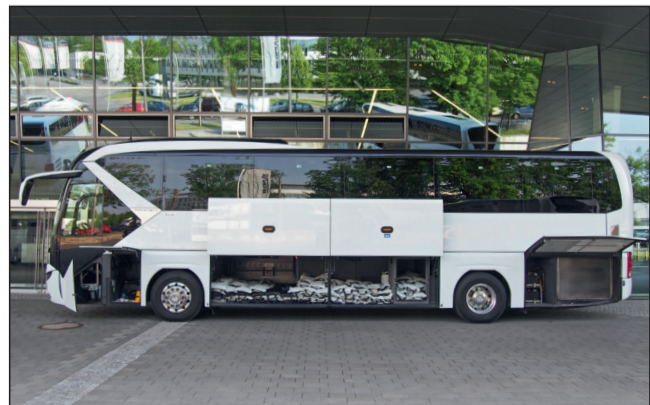
Klappen auf: Ausreichend Kofferraum mit 9,7 m 3 , die Batterien sitzen hinten links
