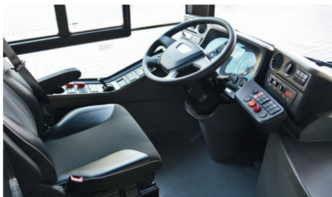
Mehr Platz im Cockpit: Lange Sitzschienen für Langbeiner, dreiteiliger Armaturenräger, das Lenkrad lässt sich ausreichend weit verstellen
