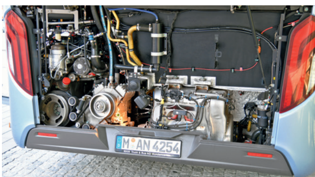
Blick unter die Heckklappe: Links im Eck der Diesel mit motorfestem Klimakompressor, rechts daneben das Abgasnachbehandlungssystem des SCR-only-Dieselmotors
