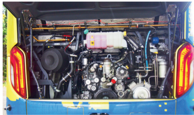
Leistung nach Maß: Anfahrstarker D15-Reihensechszylinder mit 330 PS, für schwere Topografie und hohe Fahrleistungen empfiehlt sich die 360-PS-Variante
