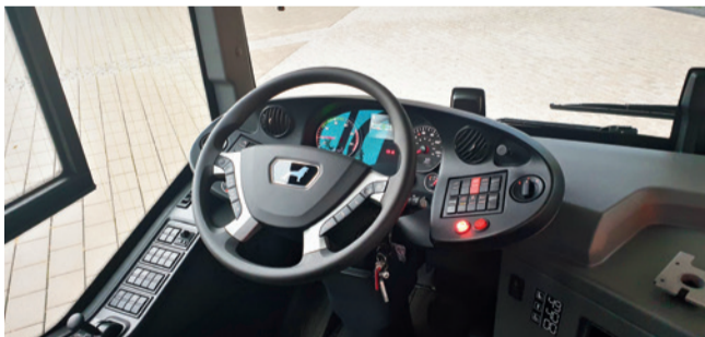
LE-Basisausstattung: Cockpit mit festmontiertem ellipsoidem Armaturenräger, im Branchenjargon „MAN-Pille“ genannt
