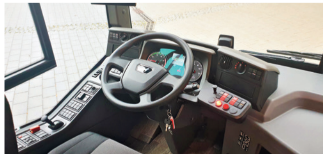
Für gehobene Ansprüche: VDV-konformer Fahrerarbeitsplatz mit verstellbarem Instrumententräger
