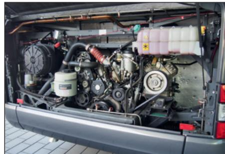
Keine Idealbesetzung: Alternativlos befeuert der D08-Sechszylinder mit 290 PS und 1.100 Nm Drehmoment den Intercity
