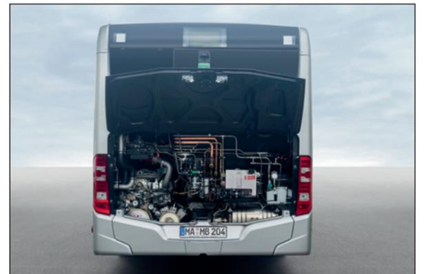
Hinter der großen Klappe: Links der Erdgasmotor M 936 G, rechts unten die Abgasanlage. Darüber positioniert sich das gesamte Tankinstrumentarium
