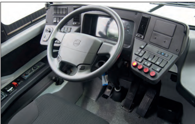
VDV-Cockpit: semioptimale stehende Pedale, tiefsitzendes Lenkrad
