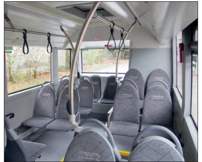
Podestfrei im Nachläufer, ein zusätzlicher Heckeinstieg ist möglich
