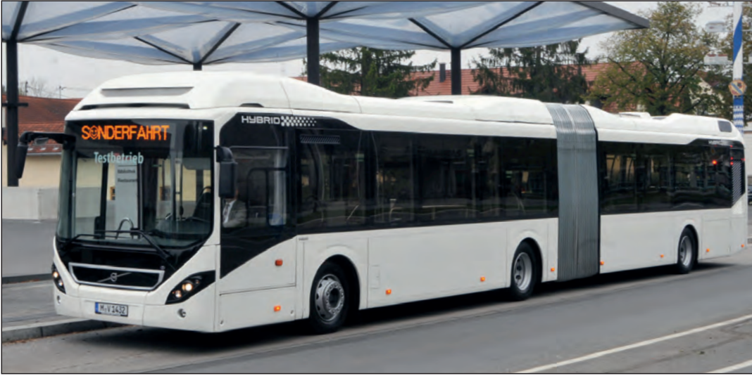
Der neue Volvo-Gelenkzug: Weniger Lärm, in den laufenden Verkehr wird elektrisch beschleunigt
