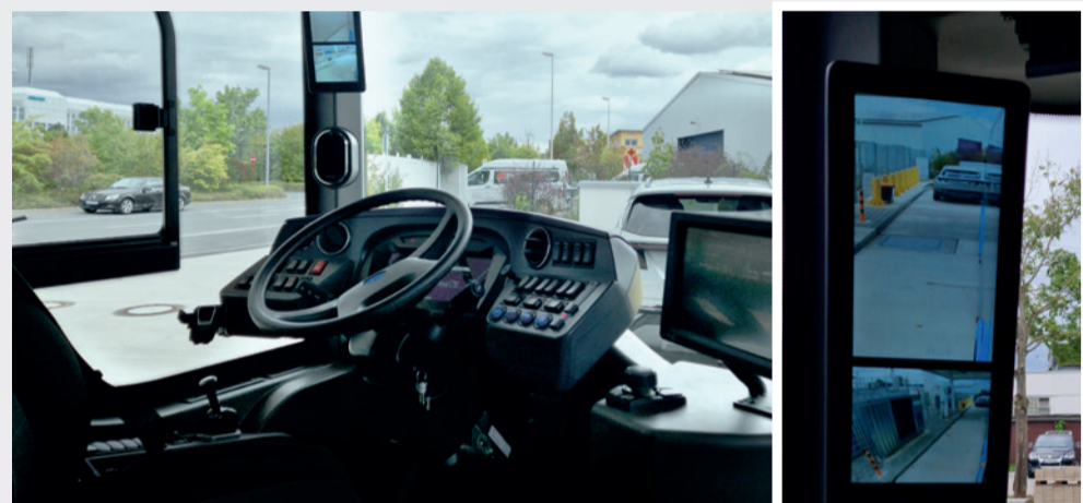
Das VDV-konforme Cockpit ist mit den neuesten Assistenzsystemen sowie Kameraspiegeln gespickt.
